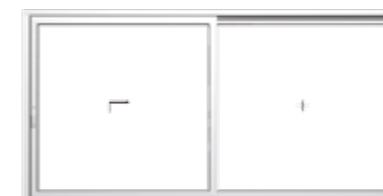
Schema A, levé 1 křídlo, 1 pevné zasklení
